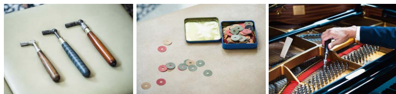
調律で使うハンマー(左)と、鍵盤の深さを調整する紙製のパンチング(中央)、調律中の様子(右) 写真：大野隆介
