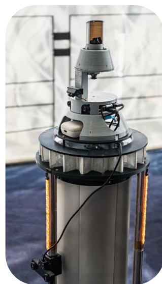
環境認識をするセンサー部は、共同企業の株式会社人工知能ロボット研究所が開発。有人空間では紫外線ランプが閉ざされ、床面のみを除菌します
