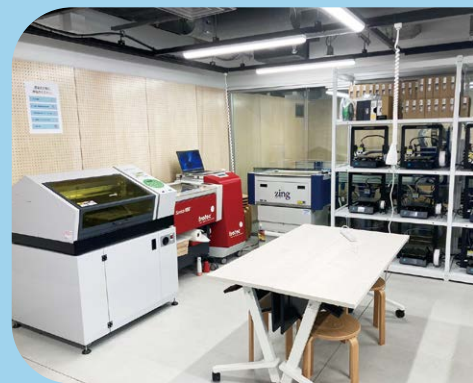
個人による自由なもののづくりの可能性を広げる実験工房「ファブラボ」。個人では所有するのが難しい3Dプリンターやレーザー加工機などのデジタル工作機器が利用できます
